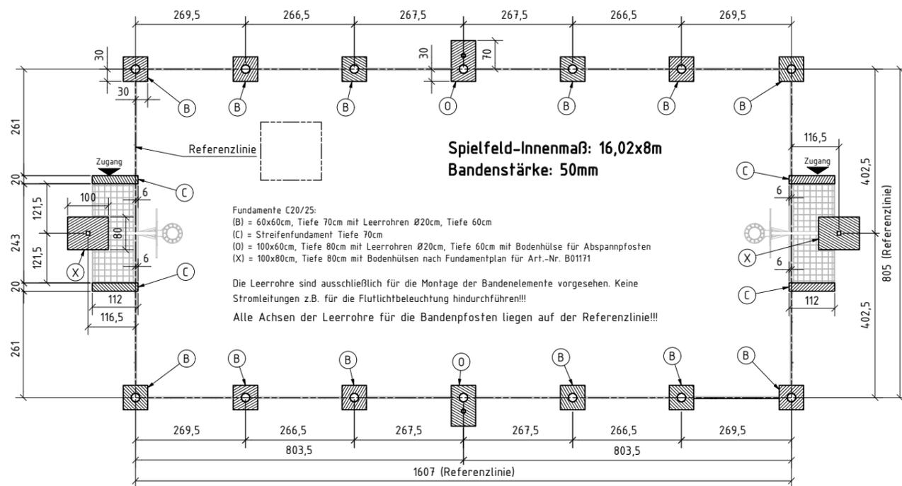
Die Streifenfundamente der Tore müssen auf Oberkante Fertigfußboden liegen. Sollten Kantensteine zur Umrandung oder Ähnliches benutzt werden, so sind diese ebenfalls auf dasselbe Höhenniveau zu setzen. Aus Sicherheitsgründen muss die Betonschicht im Spielbereich verletzungsneutral bedeckt sein (z.B. Kunstrasen)!
